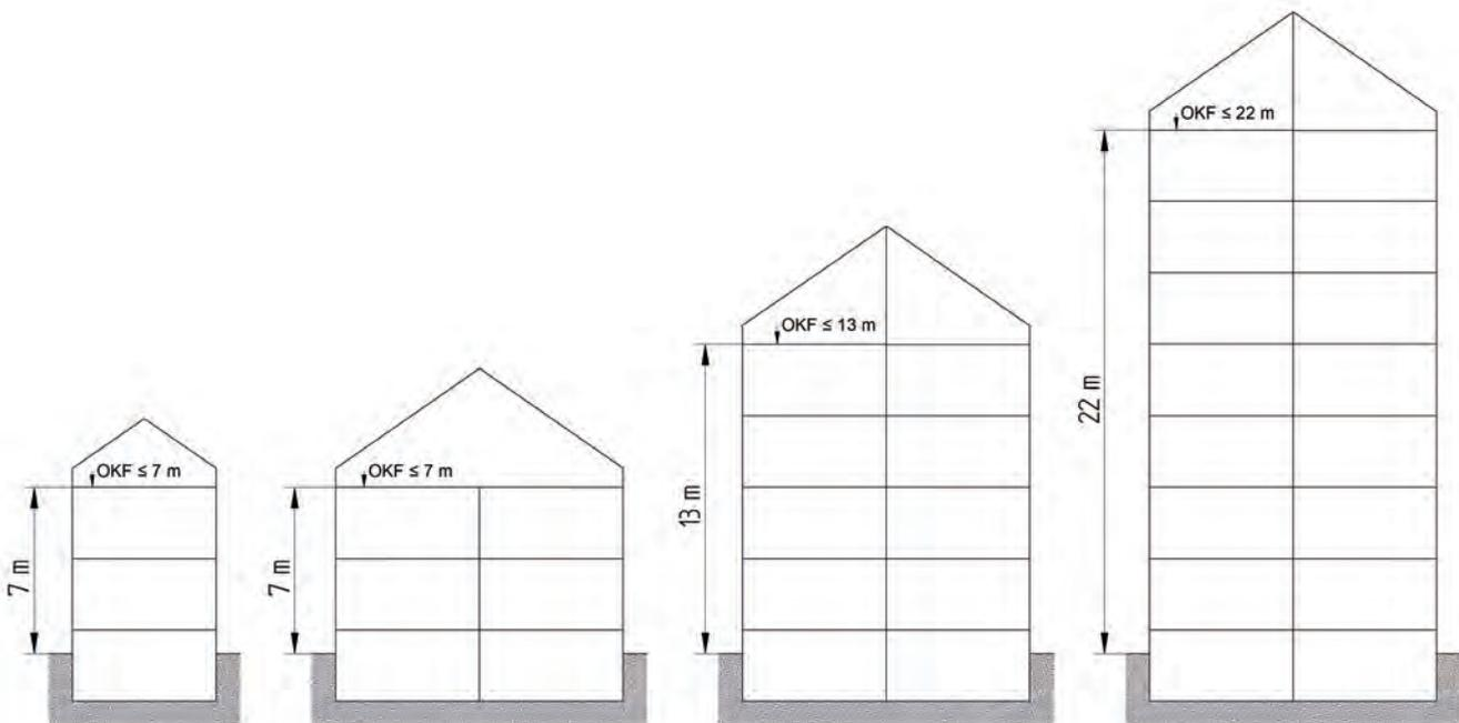
OKF = Höhe der Fußbodenoberkante des höchstgelegenen Geschosses, in dem ein Aufenthaltsraum möglich ist
