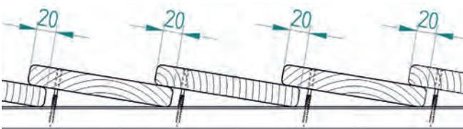
Das unterste Brett der Fassade wird dabei als erstes befestigt und danach werden alle weiteren Bretter schräg angebracht. Die Befestigung der Bretter erfolgt bei Breiten  $\leq 120$  mm mit 1 Schraube im unteren Brettbereich und bei Breiten von  $\geq 120$  mm mit 2 Schrauben. Jedes Brett muss einzeln befestigt werden.
