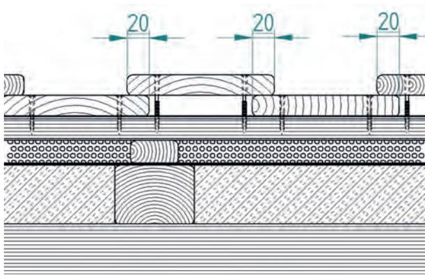
Wenn das Bodenbrett zusammen mit dem Deckelbrett verschraubt wird, können beim Quellen und Schwinden der Profile große Spannungsrisse entstehen. Die Ausführung ist nicht fachgerecht und stellt i.d.R. einen Mangel dar.
