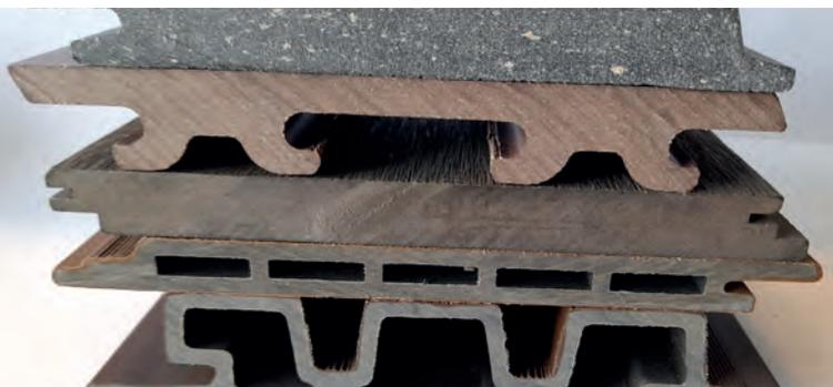
Fassadenprofile werden als Hohlkammer oder Vollprofil hergestellt.
