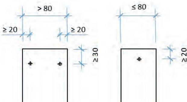
Bei Schrauben mit Bohrspitze und Reibkopf darf der Abstand von 30 mm auf 20 mm reduziert werden.
