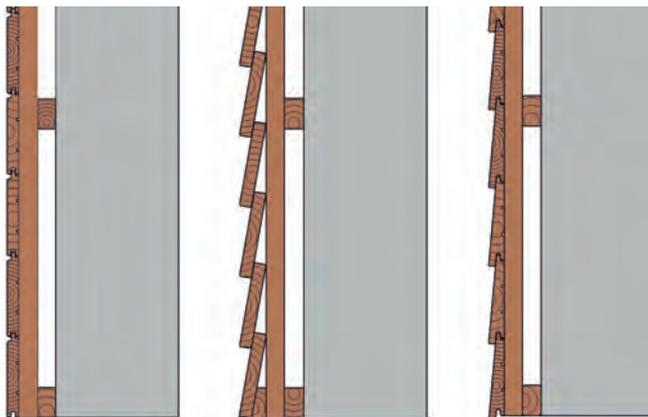
V. l. n. r.: Profilbrettkleidung, Stülpchalung mit Brettern und Stülpchalung mit keilförmigen Brettern mit Nut und Feder.
