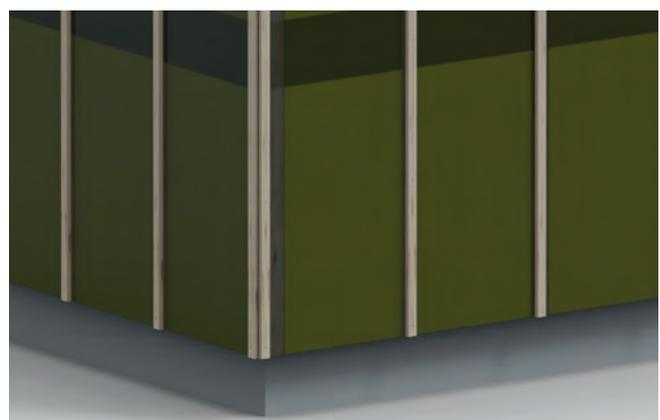
Die Fassadenbahn wird direkt auf die Wärmedämmung aufgebracht und muss mindestens 10 cm überlappen. Danach werden die Traglatten montiert.
