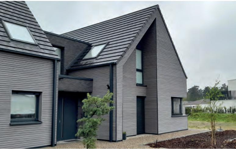
Mit einer pigmentierten Lasur kann die Vergrauung verzögert werden und eine gleichmäßigere Optik bei zurückliegenden Fassadenflächen erzielt werden.
