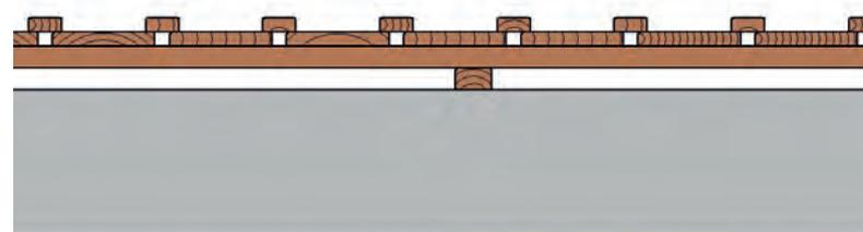
Deckleistenbekleidung und Leisten-Deckel-Bekleidung.
