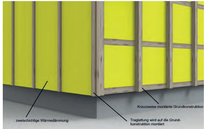
Kreuzweise montierte Grundkonstruktionen aus Holz haben sich bei vielen Fassadenbekleidungen bewährt.
