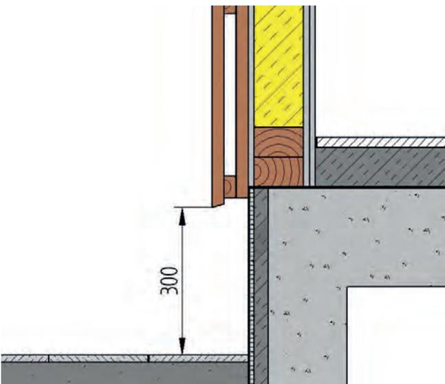
Der Abstand bei direkt bewitterten Holzbauteilen muss min. 300 mm zum Erdsreich bzw. Bodenbelag betragen. Bei z. B. HPL-Platten und Faserzementplatten kann der Abstand teilweise auf 50 mm reduziert werden. Dazu sind immer die Vorgaben der Hersteller zu den jeweiligen Produkten zu berücksichtigen.
