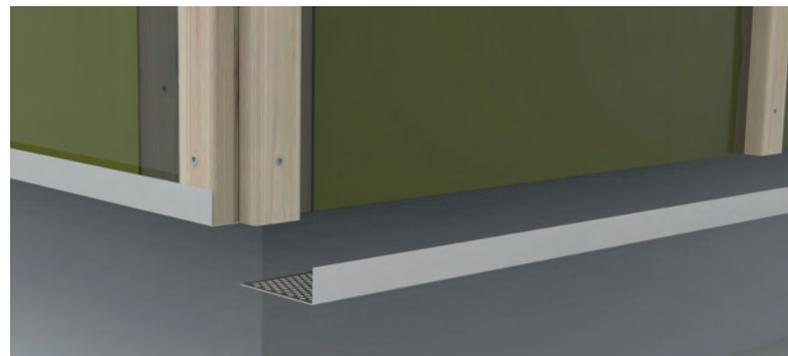
Bei hinterlüfteten und belüfteten geschlossenen Fassaden müssen geeignete Kleintierschutzgitter eingebaut werden, die die geforderten Be- und Entlüftungswerte ermöglichen.
