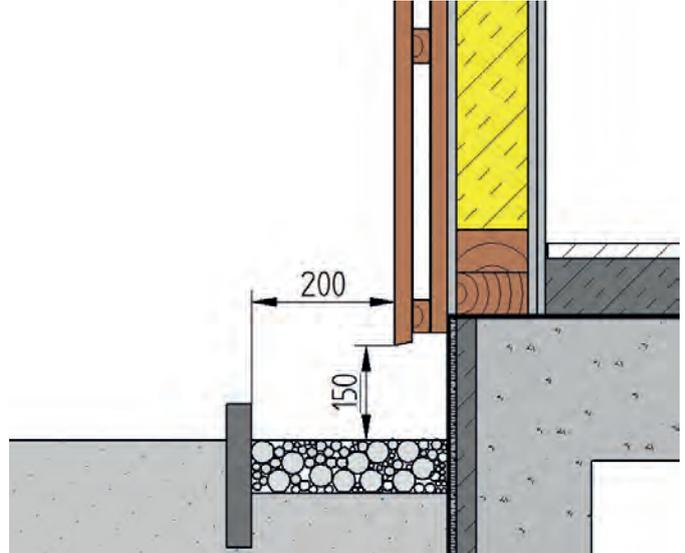
Durch konstruktive Maßnahmen wie z. B. einen 200 mm breiten Kiesstreifen (Korngröße 16/32) kann der Abstand auf 150 mm verringert werden.
