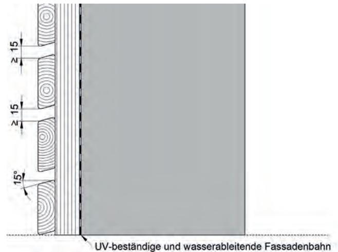
Bei waagerechten offenen Fassadenbekleidungen müssen immer UV-beständige und wasserableitende Fassadenbahnen eingebaut werden.
