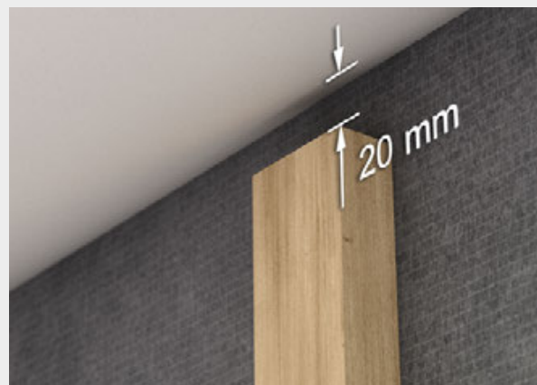
Mindestabstand zwischen Oberkante Traglattung und oberem Abschluss.
