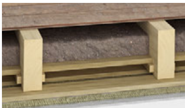
Trockenestrich-Aufbauten zum Erreichen L'_{n,w} = 50 \text{ dB} bzw. 58 \text{ dB}
