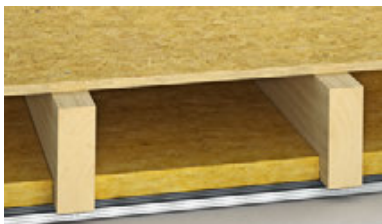
Trockenestrich-Aufbauten zum Erreichen L'_{n,w} = 50 dB
