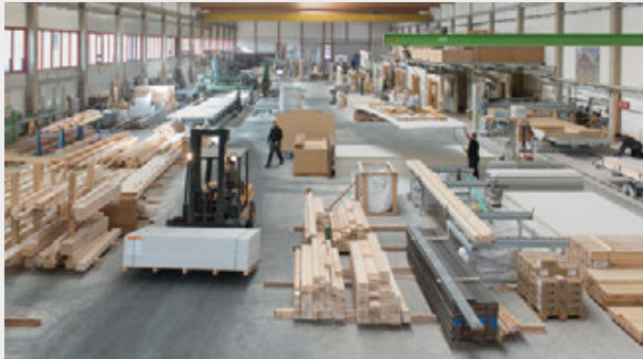
Fertigung von Holzelementen mit fermacell® Gipsfaser-Platten
