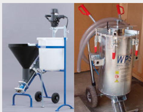
Mörtelpumpen zur Untermörtelung der Schwelle
