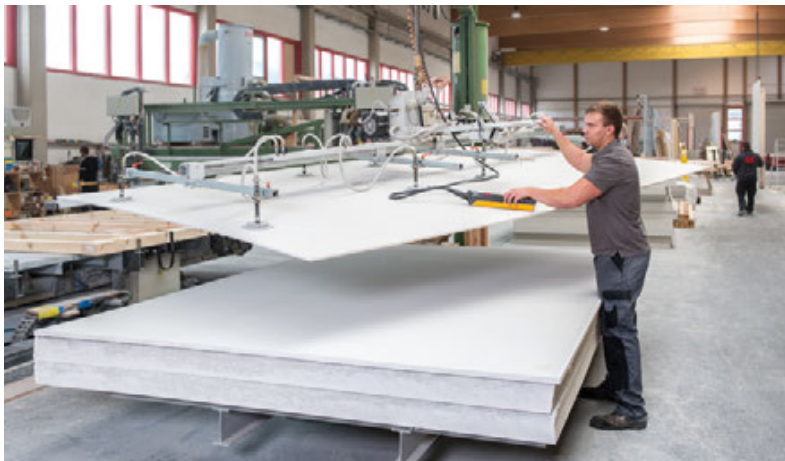
Transport von fermacell® Gipsfaser-Platten mit einem Vakuum-Hebegerät
