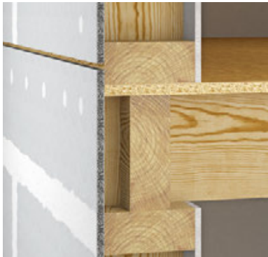
Bild 3: Mit HD-Fugentechnik versehener Bereich des Plattenstreifens
