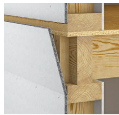
Bild 2: Montage des Plattenstreifens
