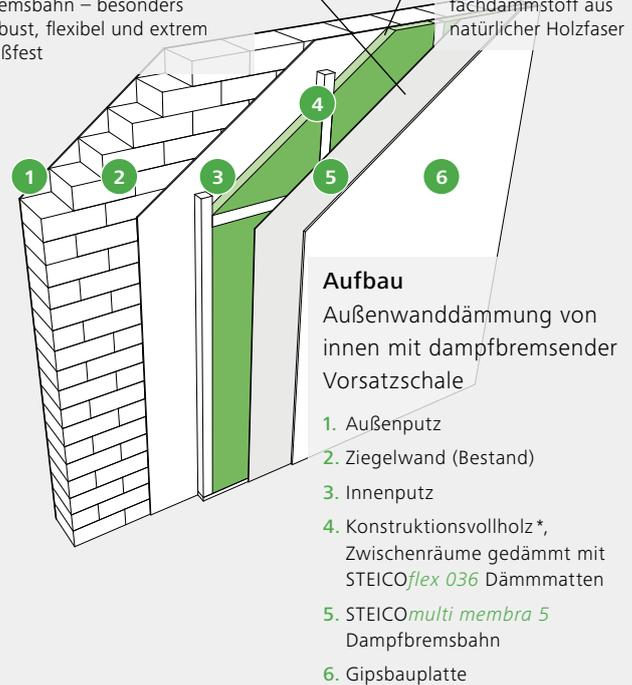
Besonders stabil mit Unterkonstruktion
