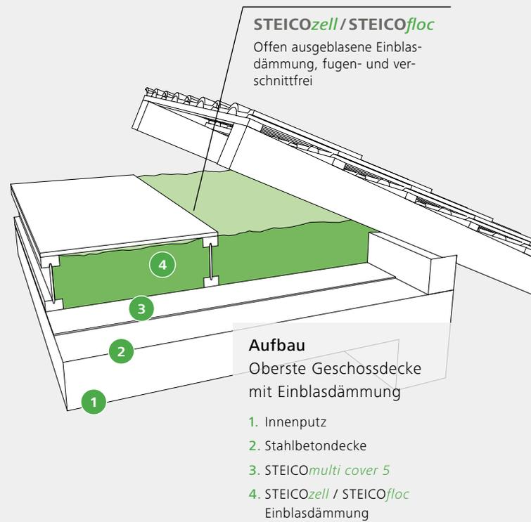
Schon mit 8 cm Dämmung mehr als 80 % U-Wert-Verbesserung möglich
