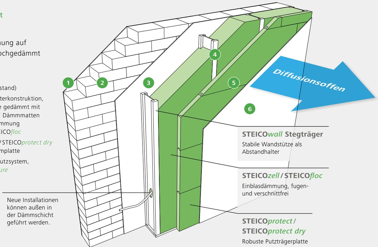
Neue Installationen können außen in der Dämmschicht geführt werden.
