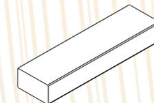
**Hartholz-Unterkonstruktion, kammergetrocknet, glatt gehobelt**
