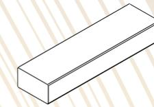
**Hartholz-Unterkonstruktion, kammergetrocknet, glatt gehobelt**
