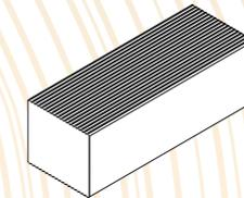
**Hartholz-Unterkonstruktion, kammergetrocknet, beidseitig geriffelt**
